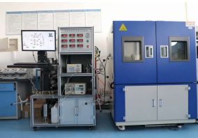
名称：稳态渗透驱替测试装置 型号：HAHC 放置地点：唐岛湾校区特种实验楼D420
