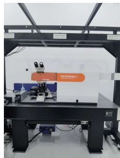
名称：原位激光拉曼光谱仪 型号：雷尼绍inViaQontor 放置地点：古镇口校区国重楼B024
