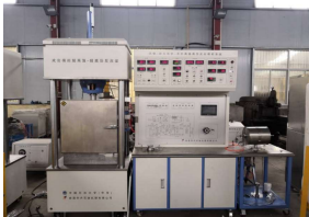
名称：高压CO 2 注入系统及高温高压模拟实验产物收集与计量系统 型号：定制产品 放置地点：唐岛湾校区特种实验楼D118-D120
